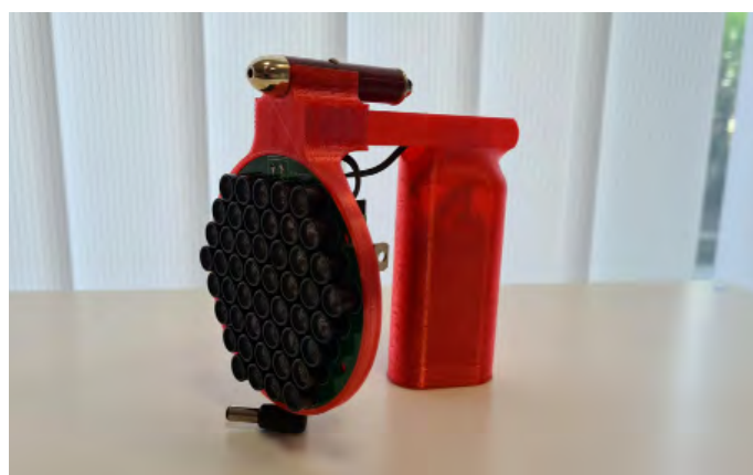
Prototyp „latarki dźwiękowej” – kierunkowego głośnika do wspomagania echolokacji
